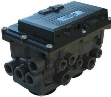
Eléments de freinage pneumatique commander électriquement par le boîtier électronique EBS et permettant de commander le freinage de façon électrique. Plusieurs systèmes permettent également d'intégrer des contrôles de charge et d'anti-basculement de charge, de correction de trajectoire et d'antipatinage.
