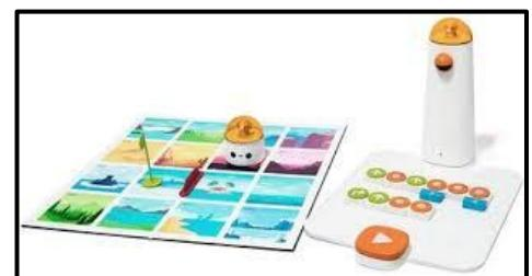
**Matatalab** est un robot **ludique, simple et programmable** à partir d'**un plateau** et d'**une tour de commande**. La programmation de ce **robot éducatif** se réalise à partir de **briques**, en respectant le sens d'écriture de la gauche vers la droite et de haut en bas. Il est idéal pour **initier** les élèves à la **programmation** de manière simple et **ludique**.
