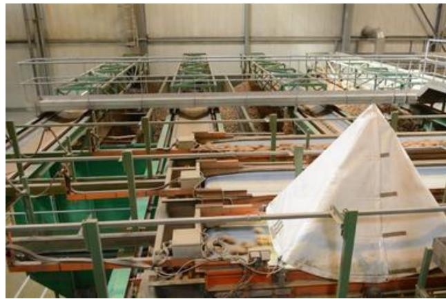
Les pommes-de-terre sont livrées dans des remorques isothermes spéciales équipées de tapis pour éviter les chocs au déchargement. Elles sont convoyées vers des calibreurs à grilles de 50 mm. Un système de caméras mesure toutes les trois secondes la longueur et la largeur des pommes de terre. L'unité comprend 20 trémies de stockage de 80 tonnes.
