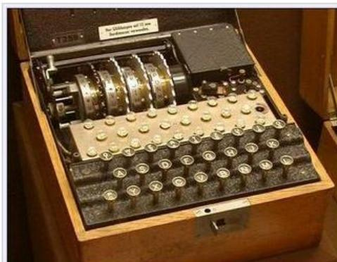
Machine de chiffrement « Enigma » à quatre rotors. On distingue : le clavier, les lampes qui donnent le résultat du message crypté ou décrypté, et les rotors.
