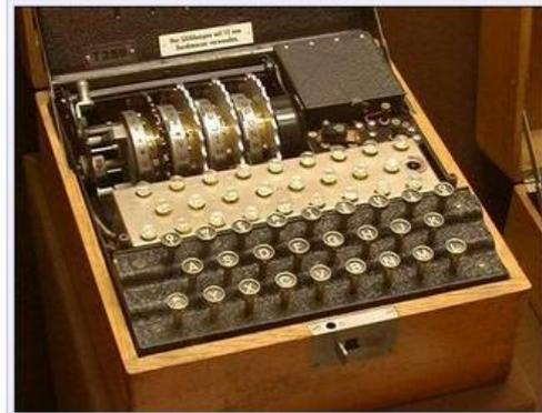
Machine de chiffrement « Enigma » à quatre rotors.
