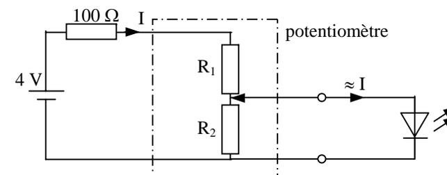
Dans ce cas, on ne devrait pas beaucoup changer le comportement du montage si l'on supprimait carrément  $R_2$  : le courant délivré par l'alimentation serait alors rigoureusement le courant traversant la LED :
