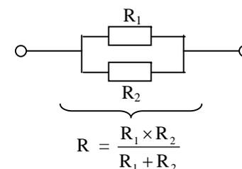
Dans ce cas la résistance équivalente à l'association vaut  $R = \frac{R_1 \times R_2}{R_1 + R_2}$
