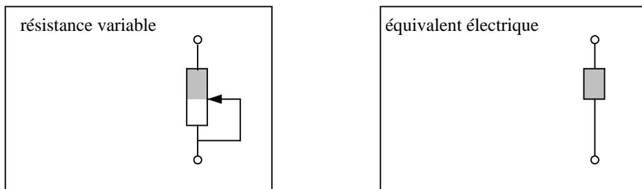
la résistance variable est donc le cas particulier d'un potentiomètre dont le curseur est connecté à l'une de ses 2 bornes. Le symbole de la résistance variable est le suivant :
