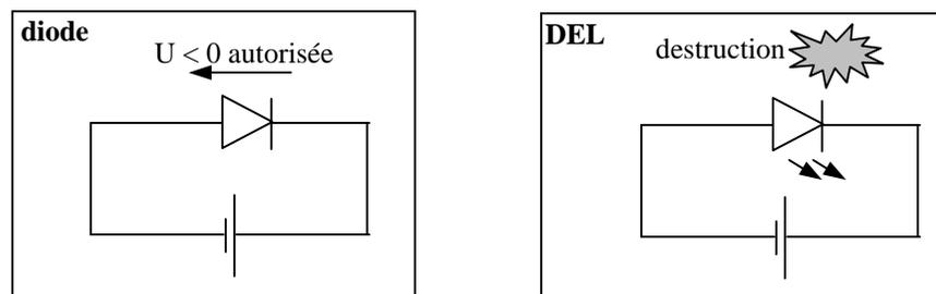
La LED, comme la diode, ne laisse passer le courant que dans le sens de sa flèche. Habituellement le courant maximal admissible par une LED est de l'ordre de 10 à 30 mA (contre plusieurs 100<sup>aines</sup> d'ampères pour certaines diodes dites "de puissance", soit 10 000 × plus).
