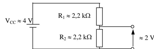
Démontrez que la tension fait bien 2 V aux bornes de la résistance  $R_2$
