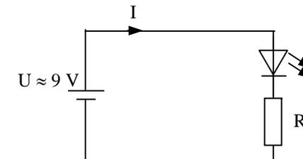
La LED possède un courant nominal de  $25 \text{ mA}$ . Sa tension nominale de fonctionnement est  $U_d \approx 1,8 \text{ V}$ .
