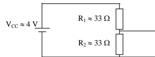
démontrez que l'on a toujours 2 V environ aux bornes de sortie du diviseur de tension.
