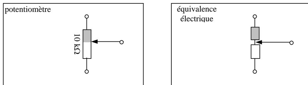
l'équivalence électrique du potentiomètre (voir ci-dessus le schéma de droite) nous montre clairement que le potentiomètre réalise exactement le diviseur de tension. On réalisera donc le montage suivant :
