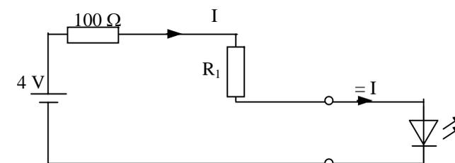
On économise ainsi le prix d'un potentiomètre. Pour ajuster  $R_1$  à la valeur trouvée à l'expérimentation n°3 précédente on utilise une *résistance variable*.
