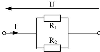
b- On a à présent  $R_1 \approx 54 \Omega$ ,  $R_2 \approx 72 \Omega$  et  $U_2 \approx 3,25 \text{ V}$ . Calculez l'intensité  $I$  et les tensions  $U$  et  $U_1$
