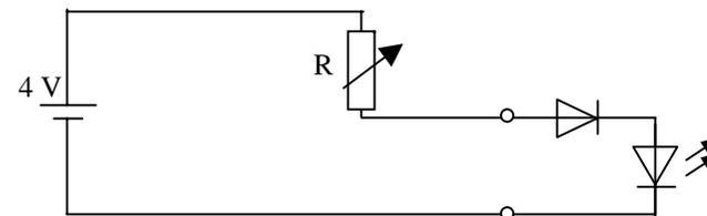
En effet, on peut facilement démontrer en traçant la somme des caractéristiques graphiques de la diode et de la LED (voir séance n°6, paragraphe 4) qu'une tension d'alimentation négative est entièrement répercutée aux bornes de la diode et non de la LED.
