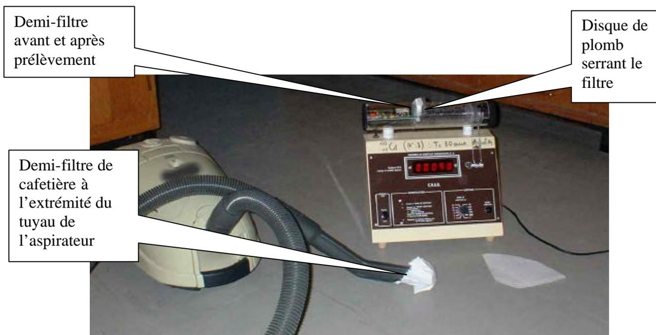
*1<sup>ère</sup> manipulation* : le filtre est séparé en deux parties de façon à disposer d'une couche de papier. La feuille obtenue est pliée de façon à entrer dans le compteur, devant la fenêtre du compteur. La mesure dure **100s** ; la manipulation est reprise trois fois et on montre que la présence du filtre n'induit pas de réponse significativement plus importante que ce qui a été obtenu sans filtre.
