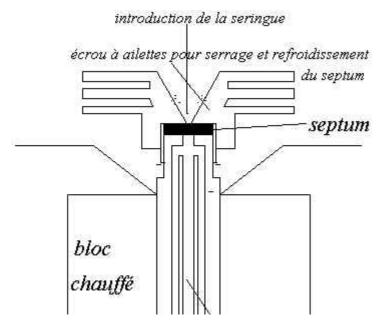
C'est le système le plus utilisé. La figure ci-contre le décrit dans son principe essentiel: le gaz porteur, de préférence préchauffé, entre dans une chambre chauffée, obturée par une pastille d'élastomère, le septum, qui assure l'étanchéité. À l'aide d'une seringue hypodermique de petite capacité, on pique au travers du septum, de telle manière que l'extrémité de l'aiguille arrive audessous du niveau de l'arrivée du gaz porteur, puis on pousse le piston
