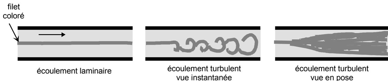
En utilisant des fluides divers (viscosité différente), en faisant varier le débit et le diamètre de la canalisation, Reynolds a montré que le paramètre qui permettait de déterminer si l'écoulement est laminaire ou turbulent est un **nombre sans dimension appelé nombre de Reynolds** et donné par :
