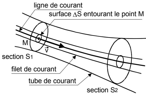
**Ligne de courant** : En régime stationnaire, on appelle ligne de courant la courbe suivant laquelle se déplace un élément de fluide. Une ligne de courant est tangente en chacun de ses points au vecteur vitesse du fluide en ce point.
