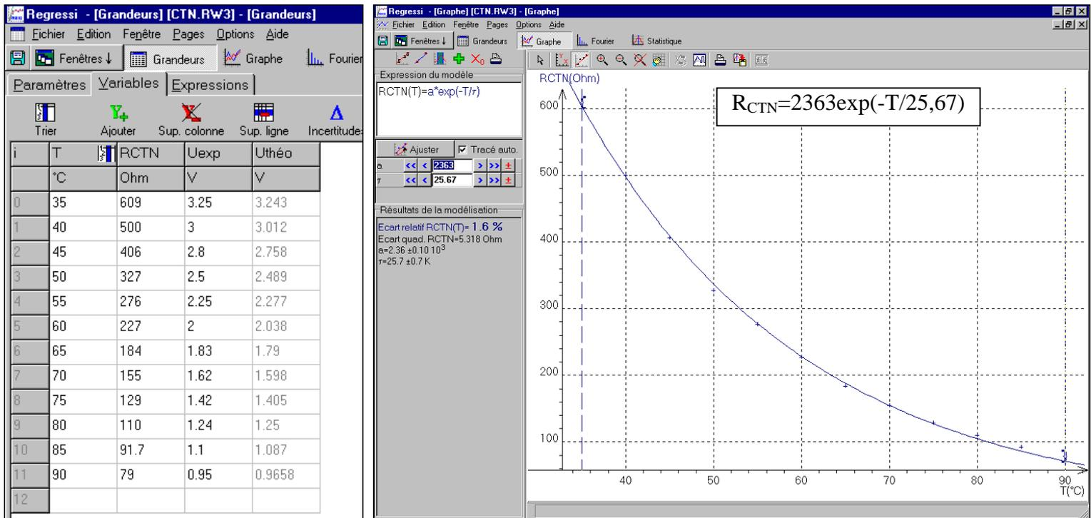
Cependant, le relevé de la température à l'aide du logiciel CTN\_GTS2\_gene.exe nécessite le modèle suivant :
