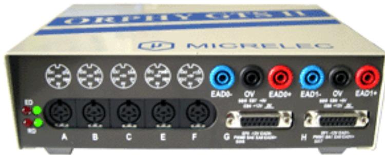
Le module d'acquisition ORPHY est un boîtier électronique qui numérise une tension présente entre les bornes EAD0- et EAD0+ <sup>(1)</sup> ou entre les bornes EAD1- et EAD1+. Il se connecte comme un voltmètre. Son prix public est de 775 € TTC en mars 2006.
