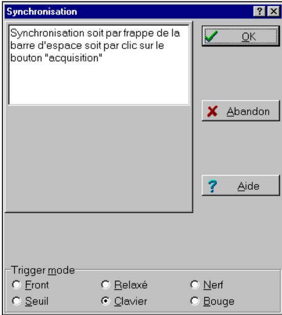
la sélection d'un mode de déclenchement (**Trigger mode**) donne accès à d'autres paramètres de réglage qu'il est inutile de détailler ici. On peut cependant constater qu'avec le mode de déclenchement **Clavier** sélectionné ici, le démarrage de l'acquisition (ce qu'on appelle la "synchronisation") s'établit par une frappe au clavier.
