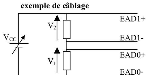
Appuyer sur la barre d'espace pour voir le point ( $V_1$ ,  $V_2$ ) correspondant sur le graphe. On peut alors modifier la valeur de  $V_{cc}$  sur l'exemple de câblage ci-dessus puis tracer un nouveau point en appuyant sur la barre d'espace.
