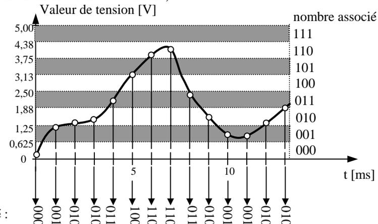
**8.** le calibre du convertisseur 3 bits précédent est de 5 V, c'est-à-dire que la tension maximale qu'on peut lui appliquer est 5 V sous peine de destruction. A cette valeur de tension correspond le nombre maximal sur 3 bits, c'est-à-dire 111...
