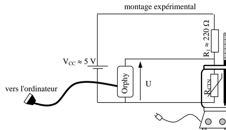
Orphy est un *module d'acquisition*, c'est-à-dire un appareil qui numérise la (ou les) tension(s) qu'on lui applique. On branche le module à l'ordinateur via un câble série qui se branche sur le port série COM 1 ou COM 2 de l'ordinateur.
