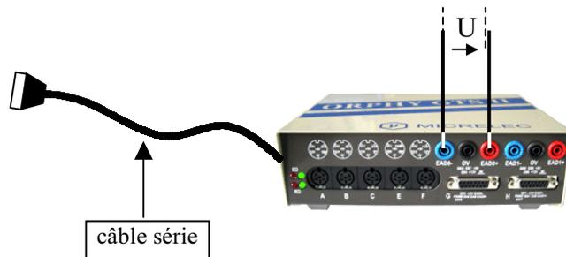
Ensuite on met le module sous tension (Marche / Arrêt à l'arrière droit du module) puis on applique la tension U à numériser sur la voie EAD0, c'est-à-dire entre les bornes EAD0- et EAD0+. On peut également appliquer une tension sur la voie EAD1.
