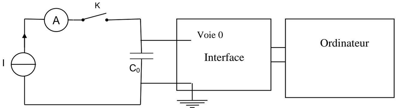
1. A l'instant  $t = 0$  on ferme l'interrupteur  $k$ . Faire un schéma représentant  $u_{C_0}$ ,  $I$ ,  $q$  (charge du condensateur) puis donner la relation entre  $I$ ,  $C_0$ ,  $u_{C_0}$  et  $t$ .
