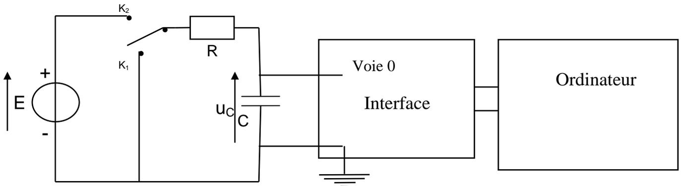
A l'instant initial, le condensateur est déchargé, on bascule alors l'interrupteur en position  $K_2$ .
