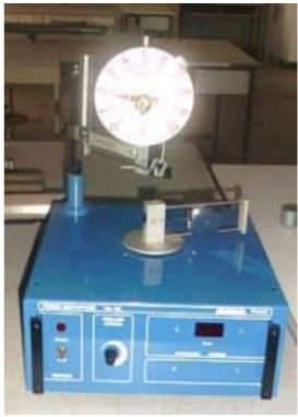
L'appareil est constitué d'un plateau entraîné en rotation par un moteur électrique. Un variateur de vitesse mécanique permet d'obtenir des vitesses de rotation comprises entre 0 et 150 tr/min environ.
