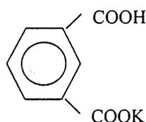
En considérant que la solution d'hydroxyde de sodium est bien de  $0,1000 \text{ mol.L}^{-1}$ , quelle doit-être la masse approximative à peser d'hydrogénophthalate de potassium pour obtenir une chute de burette de 10 mL environ (hydroxyde de sodium dans la burette).
